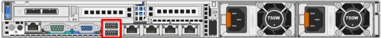
3. Connectez un câble d'alimentation à chacune des deux alimentations à l'arrière de l'appliance. Connectez les câbles d'alimentation à une source d'alimentation. Pour fournir une configuration plus robuste, connectez chaque alimentation à un circuit différent.
