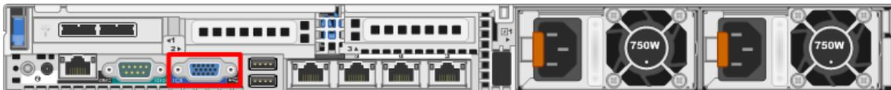
2. Schließen Sie eine Tastatur oder einen KVM-Adapter an einen der USB-Ports auf der Rückseite der Appliance an.
