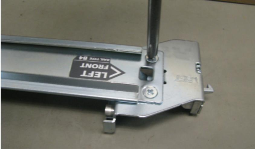
4. Entfernen Sie die Halterung und ersetzen Sie sie durch die neue Halterung.
