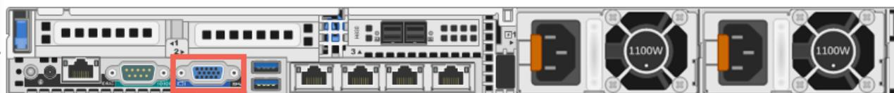
Die folgende Abbildung zeigt die Position des VGA-Ports der Hybrid Appliance.
