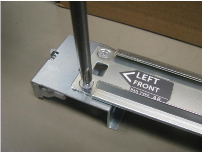
4. Entfernen Sie die Halterung und ersetzen Sie sie durch die neue Halterung.
