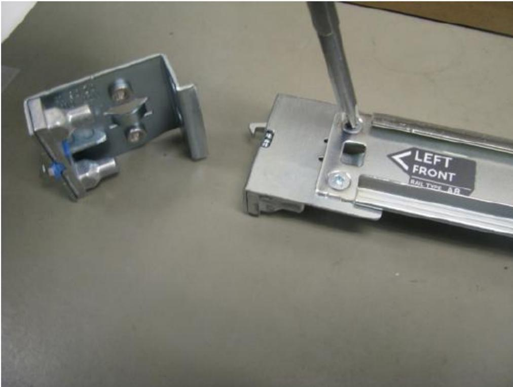
Die Schiene ist jetzt bereit für die Installation der R630-Appliance.
