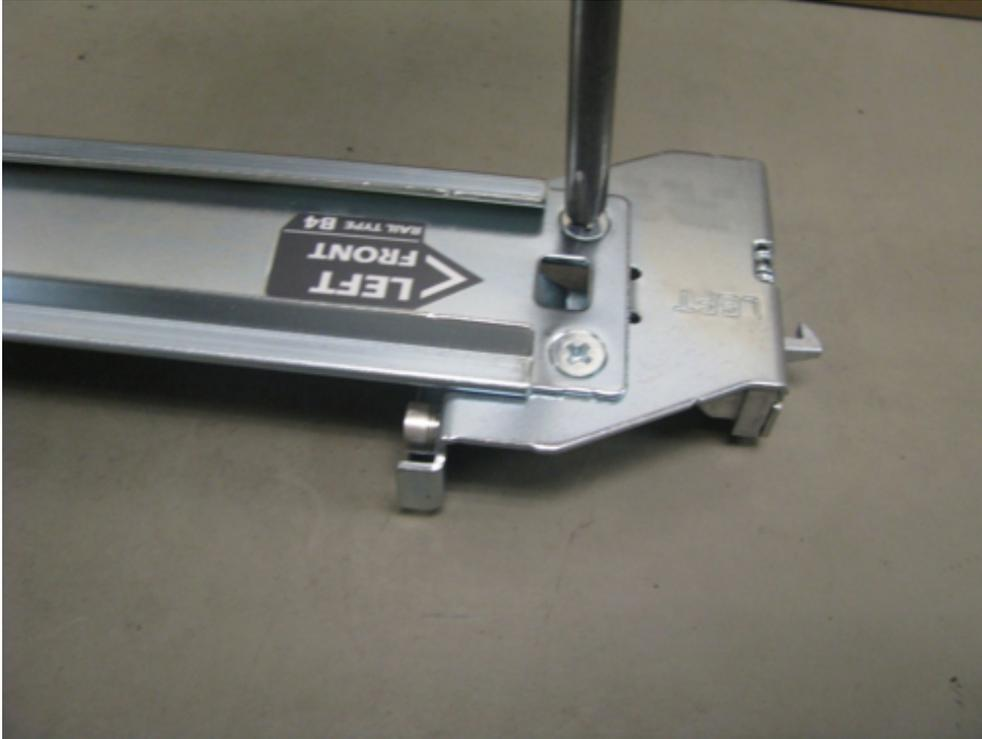
Die Schiene ist jetzt bereit für die Installation der R730xd-Hybrid Appliance.
