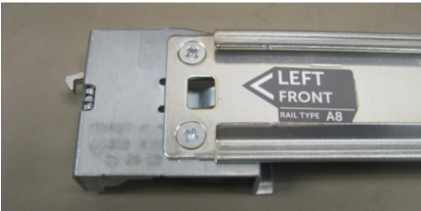
3. Verwenden Sie einen Kreuzschlitz-Schraubendreher, um die beiden Befestigungsschrauben zu entfernen.
