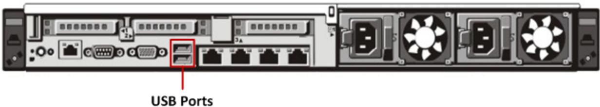
3. アプライアンスの背面にある2基の電源装置に電源コードを接続します。電源コードを電源に接続します。より堅牢な構成にするには、各電源装置を別の回路に接続します。
