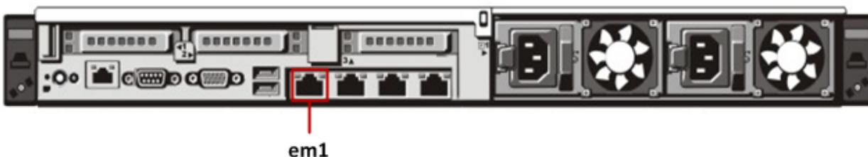
2. アプライアンスの電源コネクタと電源コンセントに電源コードを接続します。
